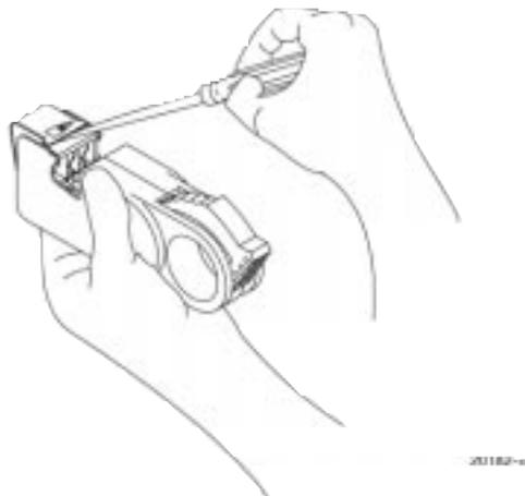
2. 用适当的力将内置刀片架从支架上取下，并从剥线工具上移去。
