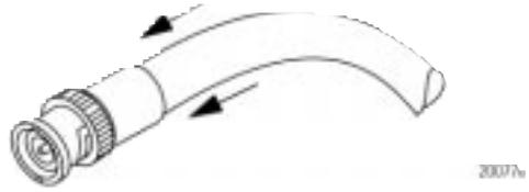
6. 使用压边工具压接金属套环。将压边工具定位在金属环上，尽量靠近连接器基部和金属环与线缆连接的位置。在金属环上使劲压压边工具，直到压接工具允许松开为止。
