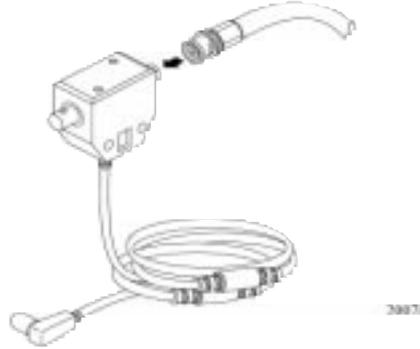
6. 将 $75\Omega$ 的终端电阻安装到分接器的另一个BNC头连接器。
